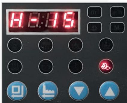
Il est recommandé de modifier en appuyant sur la touche "MENU", et au moyen des touches "MONTER" / "DESCENDRE", sélectionner H-00 et confirmer à nouveau avec "MENU".
