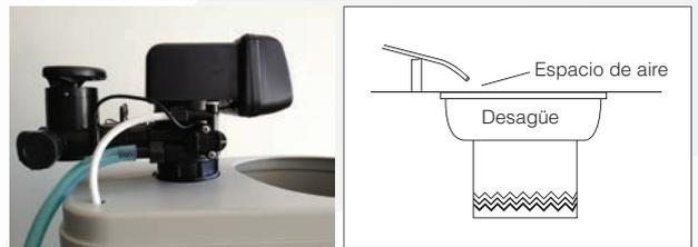
12. Coloque también un tubo desde la salida del rebosadero al desagüe (línea de drenaje) para evitar una posible inundación en caso de una programación incorrecta, o una fuga de agua por montaje inadecuado o por un fallo de la válvula. El nivel de desagüe deberá estar por debajo de la salida al rebosadero.
