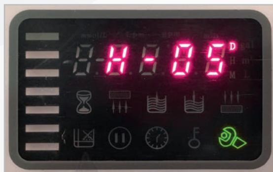
Il est recommandé de modifier en appuyant sur la touche "MENU", et au moyen des touches "MONTER" / "DESCENDRE", sélectionner H-00 et confirmer à nouveau avec "MENU".
